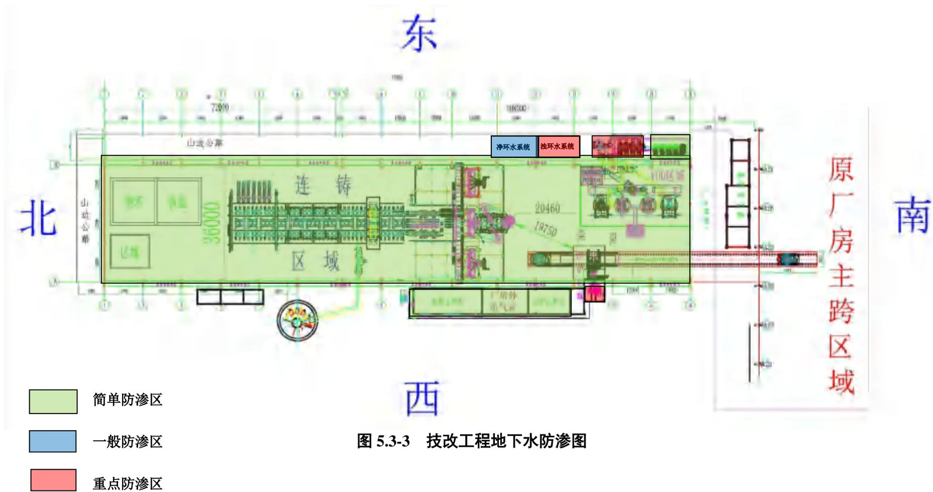
图 5.3-3 技改工程地下水防渗图
